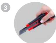
**3** Prédécoupez le film avec le cutter à un format supérieur de 2 à 3 cm à celui du vitrage
